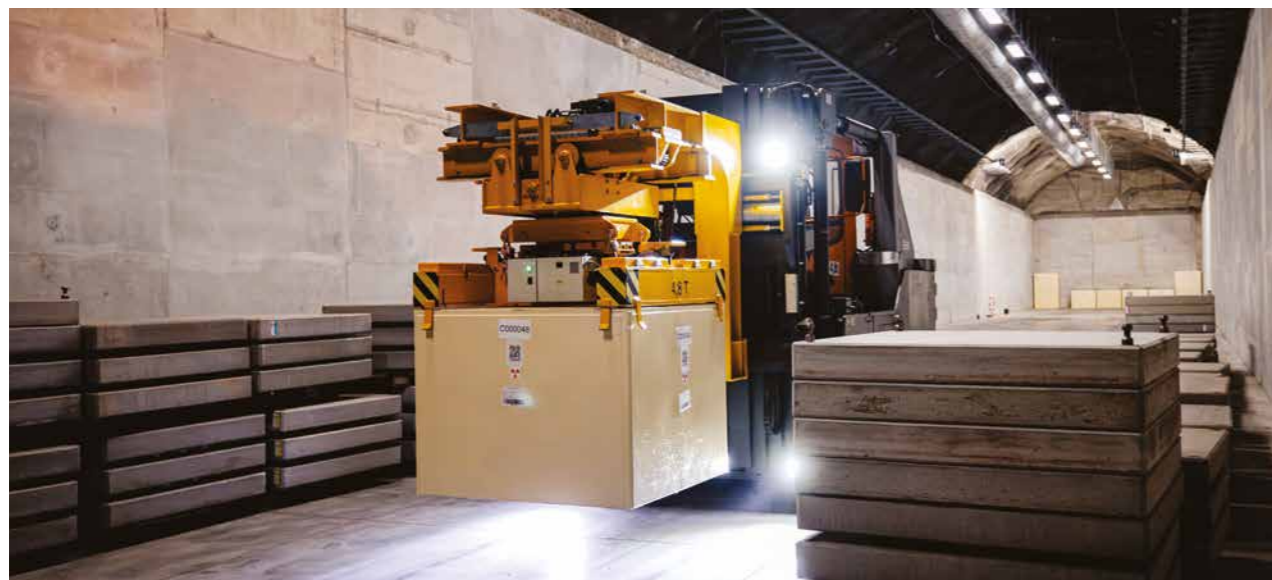
Szelvényenként 6 oszlopban és 5 sorban helyezhetők el a konténeres, valamint az oszlopok között fennmaradó helyekre 2 hordóból álló egységcsomagokat is egymásra helyeznek. A legfelső konténeres tetejére árnyékoló fedlap is kerül.
