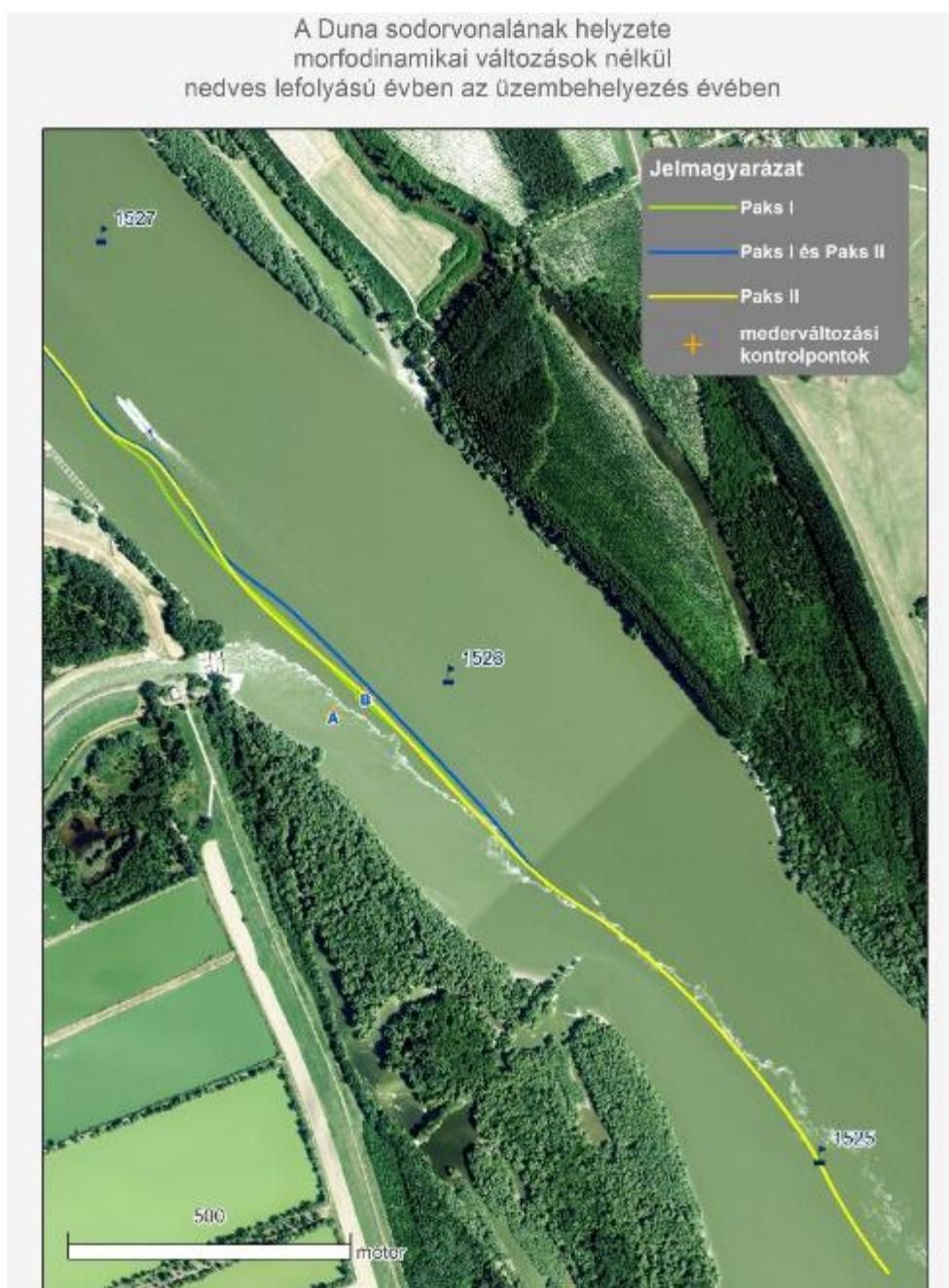
Slika 60: Proračunate promene matice u slučaju protoka od 3 000 m<sup>3</sup>/s (kišna hidrološka godina) u tri radna perioda: Nuklearna elektrana Paks samostalno, Nuklearna elektrana Paks i Paks II zajedno, Paks II samostalno
