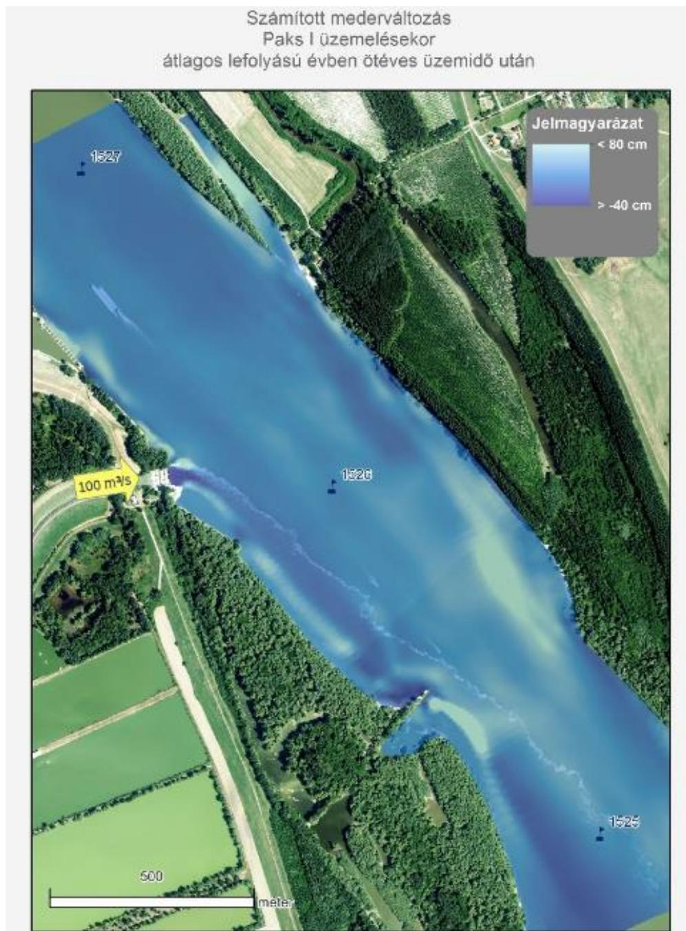
Slika 61. Proračunate promene korita Dunava nakon 5 godina rada elektrane, pri protoku od  $2.300 \text{ m}^3/\text{s}$  (prosečna hidrološka godina) i crpljenju rashladne vode  $100 \text{ m}^3/\text{s}$  – samostalni rad Nuklearne elektrane Paks (2014-2025.)
