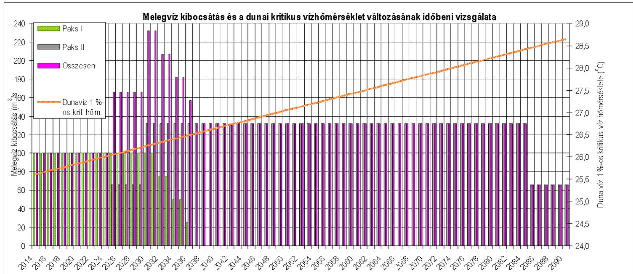
melegvíz kibocsátás és a dunai kritikus vízhőmérséklet változásának időbeni vizsgálata-temporal analysis of warm water emission and the critical water temperature changes of the Danube
