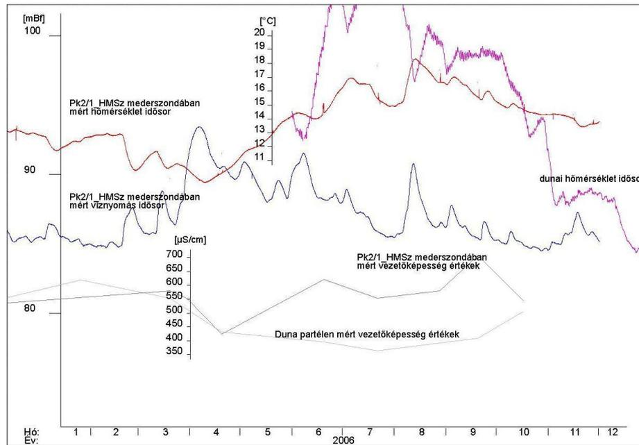
Pk 2/1 HMSz mederszondában mért hőmérséklet idősor-Temperature time series measured in riverbed probe Pk 2/1 HMSz
