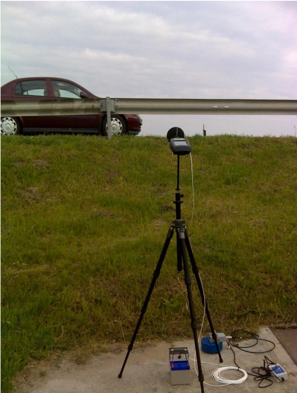
Abbildung 2-3. Anbringung des Messmikrophones am Messpunkt ZMP9 während der Aufnahme des Ausgabzustandes des Umweltlärmes
