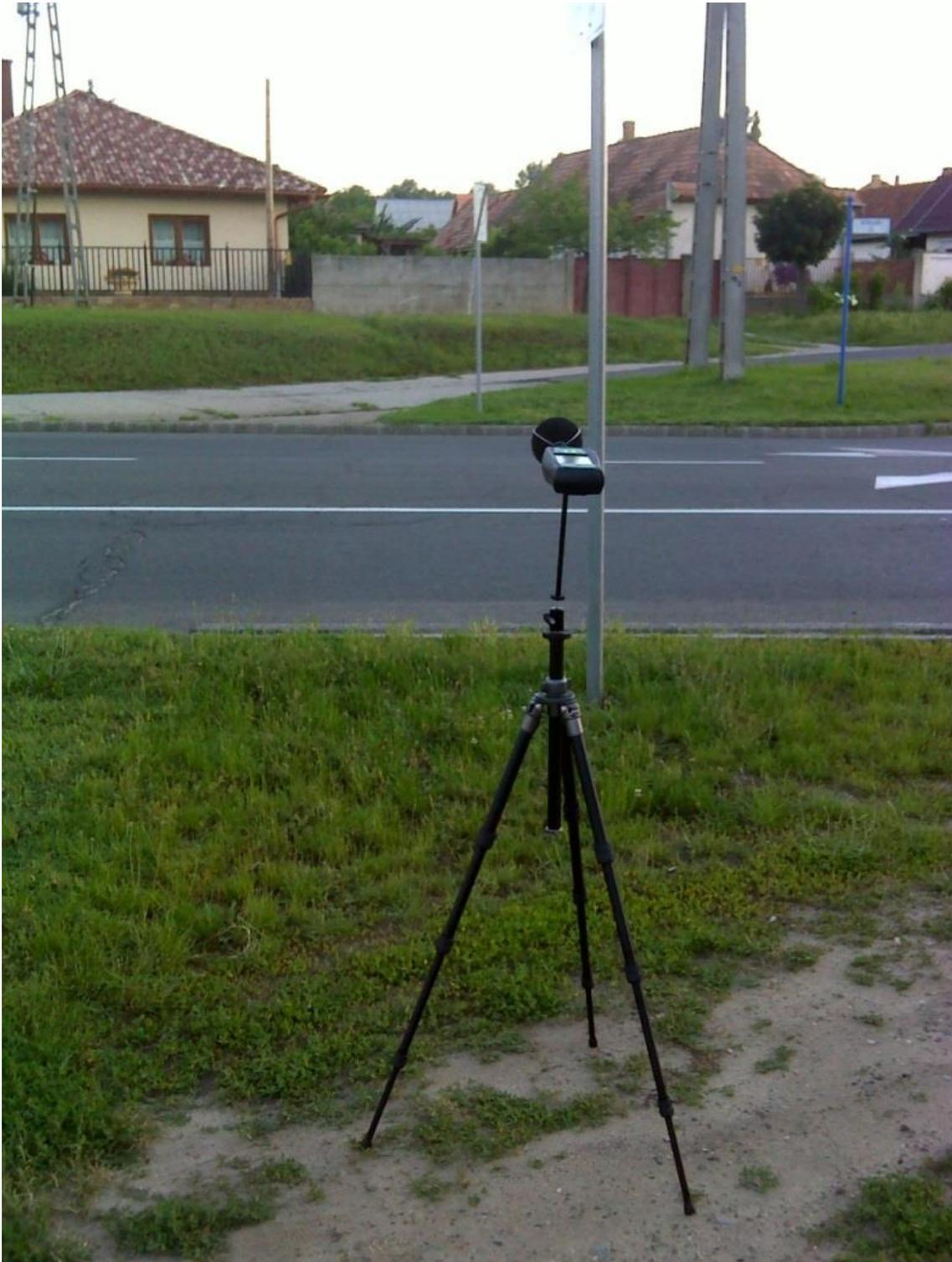
Abbildung 2-7. Anbringung des Messmikrophones am Messpunkt ZMP13 während der Aufnahme des Ausgangszustandes des Umwältlärms
