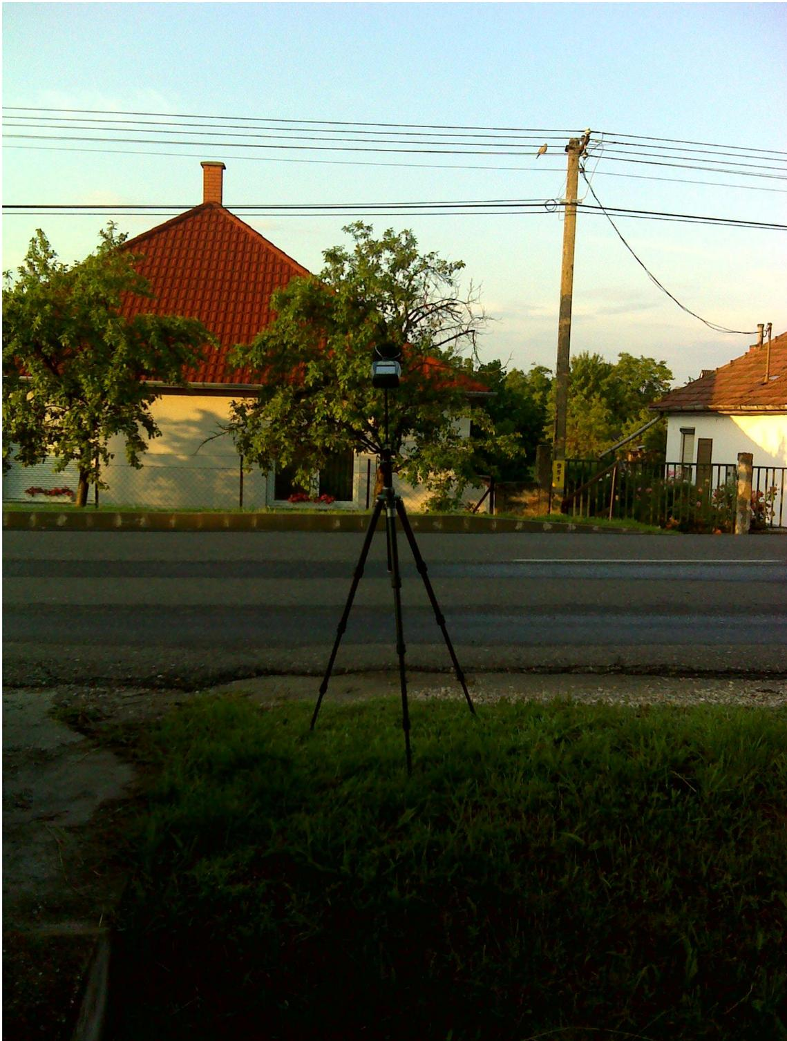
Abbildung 2-6. Anbringung des Messmikrophones am Messpunkt ZMP12 während der Aufnahme des Ausgangszustandes des Umwältlärmes
