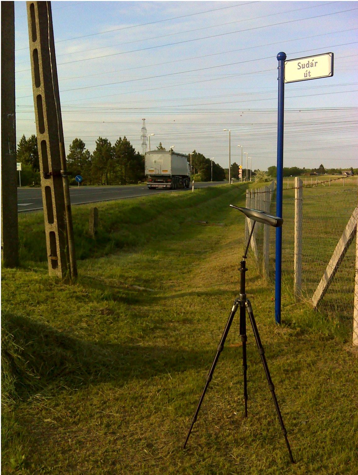
Abbildung 2-4. . Anbringung des Messmikrophones am Messpunkt ZMP5 während der Aufnahme des Ausgangszustandes des Umweltlärms
