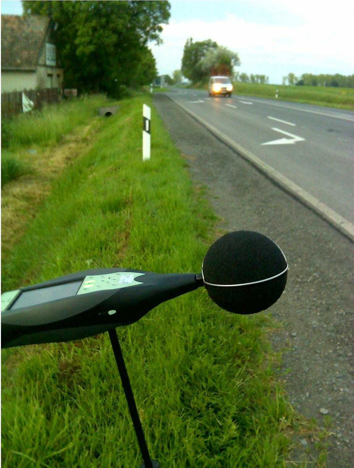
Abbildung 2-5. Anbringung des Messmikrophones am Messpunkt ZMP14 während der Aufnahme des Ausgangszustandes des Umweltlärms
