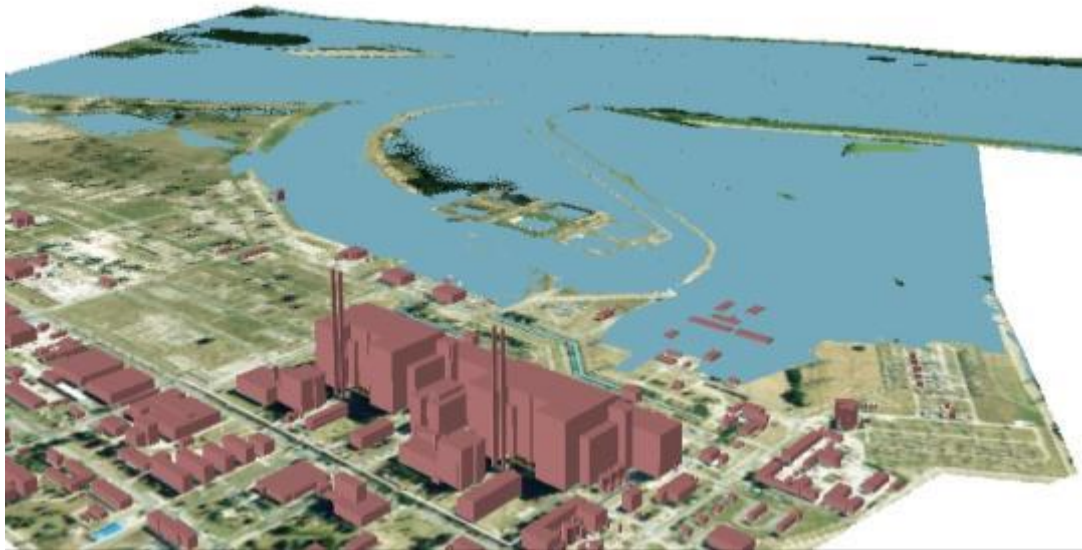
Рис. 55: Статична картина затоплення при рівні води на Дунаї 96,90 м над рівнем моря.
