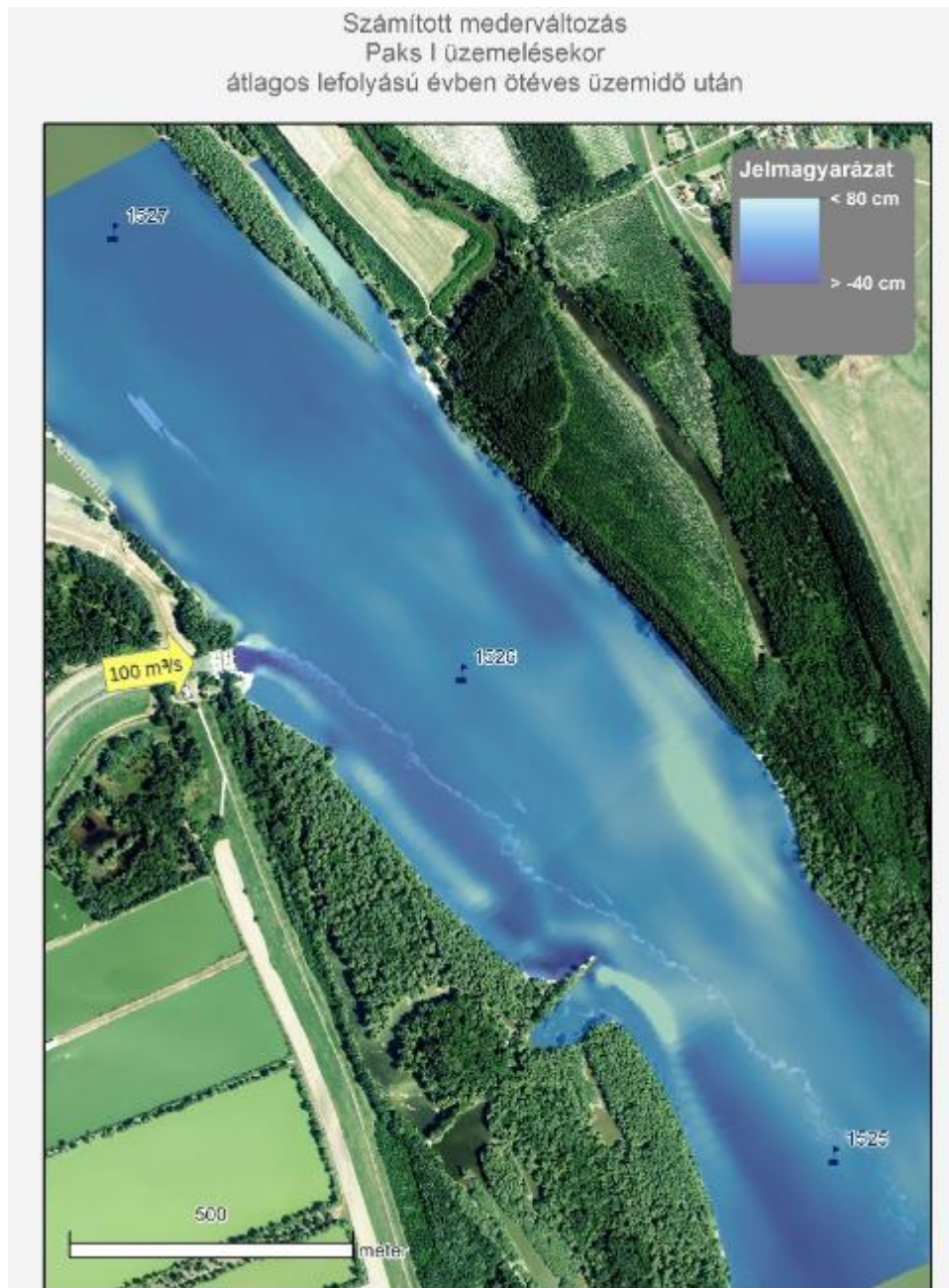
Рис. 61: Розраховані зміни у руслі Дунаю після 5-річної експлуатації із стоком води 2 300 м³/сек (середній гідрологічний рік) при значенні забору та відводу води 100 м³/сек – АЕС Пакш у самостійному режимі експлуатації (2014-2025)
