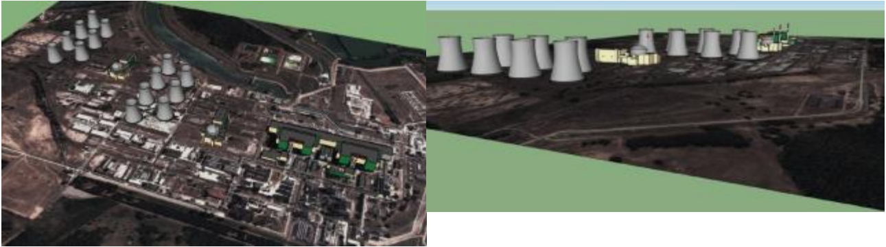
Рисунок 28: Мокрі баштові градирні з природною тягою та висотою, обмеженою до 100 м - план панорами (вид з висоти пташиного польоту та збоку)
