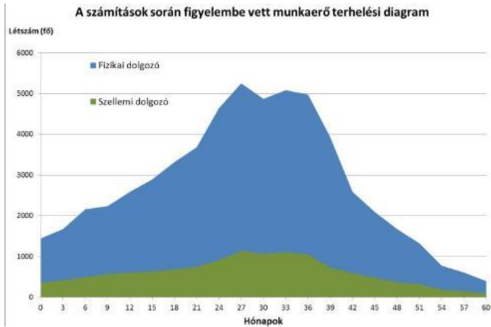
Рисунок 40: Діаграма навантаження робочої сили на виробничій території, яка була взята до уваги під час розрахунків [33], [37], [38]
