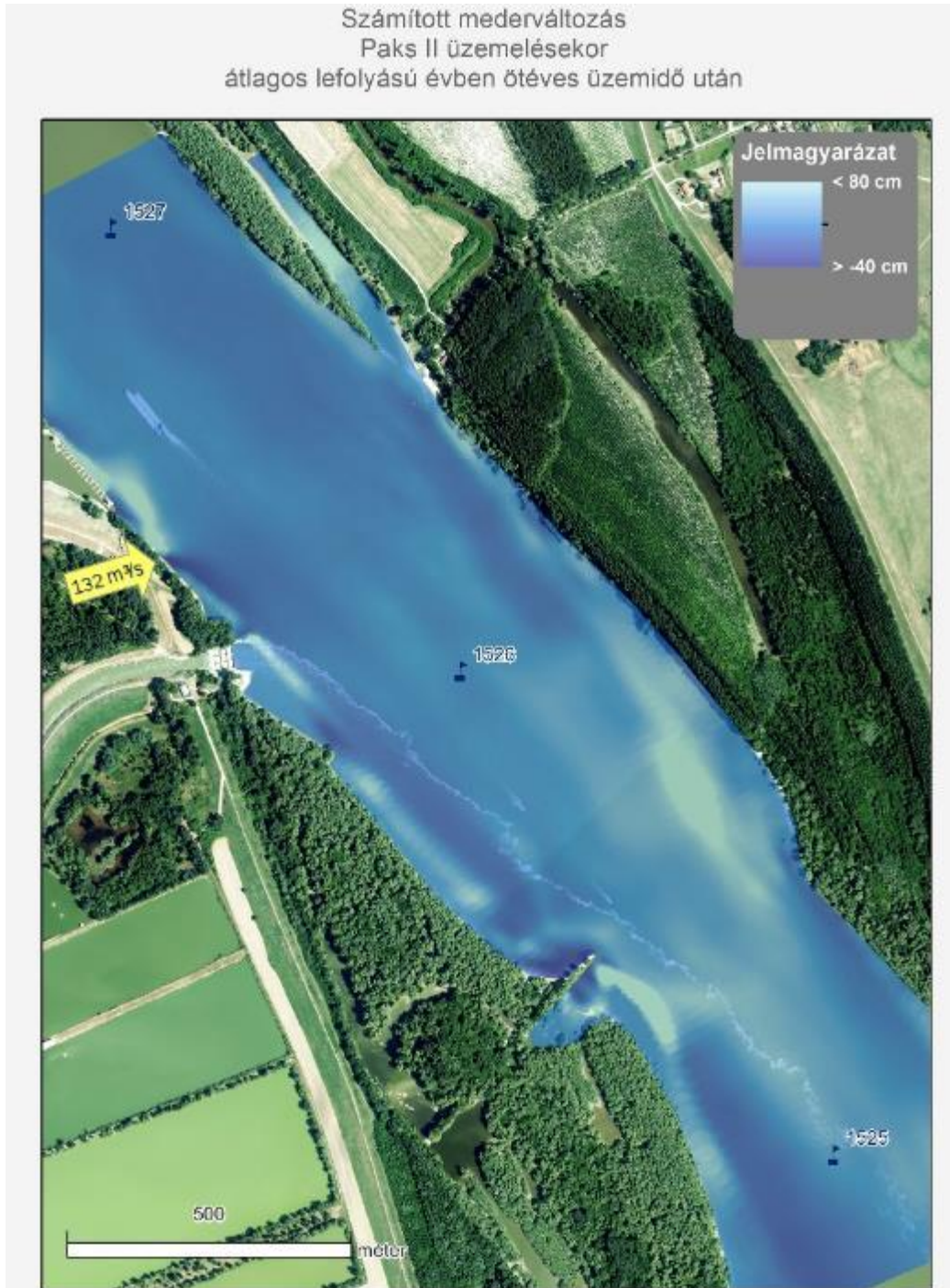
Рис. 63: Розраховані зміни у руслі Дунаю після 5-річної експлуатації із стоком води 2 300 м³/сек (середній гідрологічний рік) при значенні забору охолоджуючої води 100 м³/сек – (стан на період 2037-2085 рр.) Пакш II у самостійному режимі експлуатації (2037-2085)
