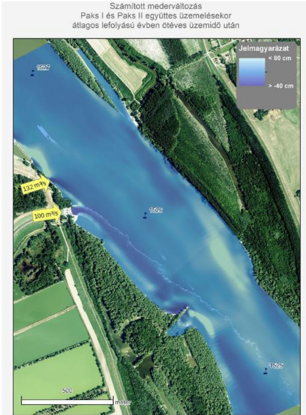
Рис. 62: Розраховані зміни у руслі Дунаю після 5-річної експлуатації із стоком води 2 300 м³/сек (середній гідрологічний рік) при значенні забору та відводу води 100 м³/сек – (стан на період 2030-2032 рр.) АЕС Пакш I і Пакш II у сумісному режимі експлуатації (2030-2032)
