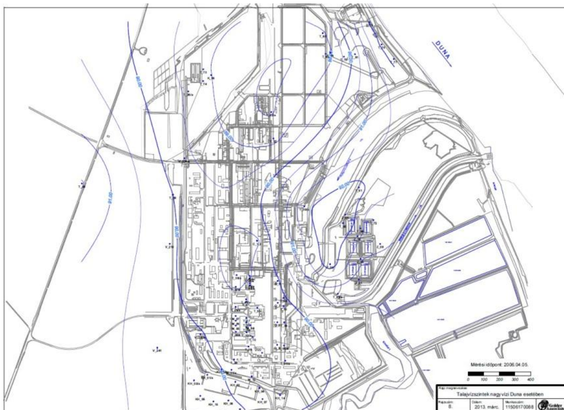
4.12-8. ábra: Talajvízszintek nagyvízi Duna esetében
