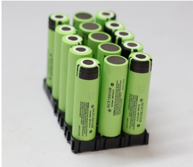
18650-es akkumulátor cella (a számok arra utalnak, hogy 18 mm széles és 65 milliméter hosszú). Ilyeneket használnak sok notebookban, de egyes autók akkumulátora is ezekből áll.
