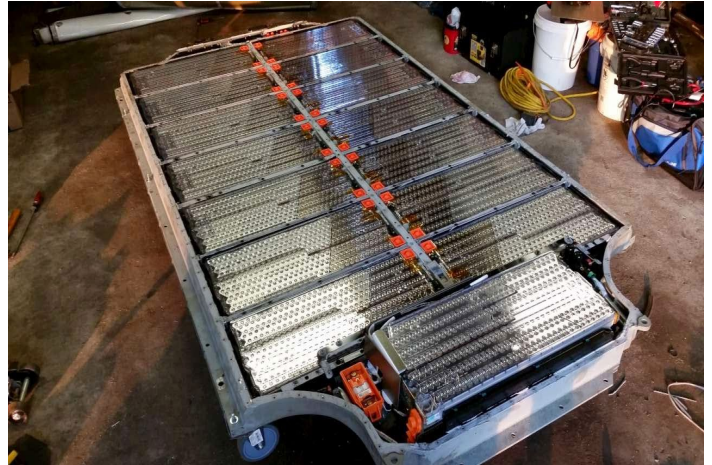
Személyautó alvázába épített akkumulátor cellák - összesen 6912 darab
